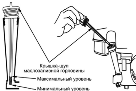
Рис. 7 Проверка уровня масла в картере
