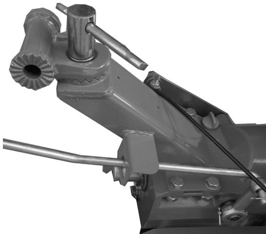
2. Установите верхние рукоятки управления, используя болты с гайкой из комплекта крепежа;
